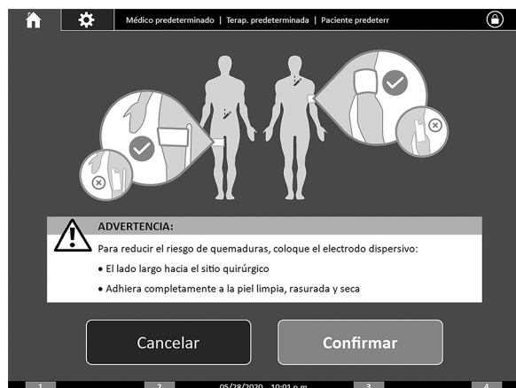
Figura 27. Ejemplo de una orientación correcta del electrodo dispersivo
